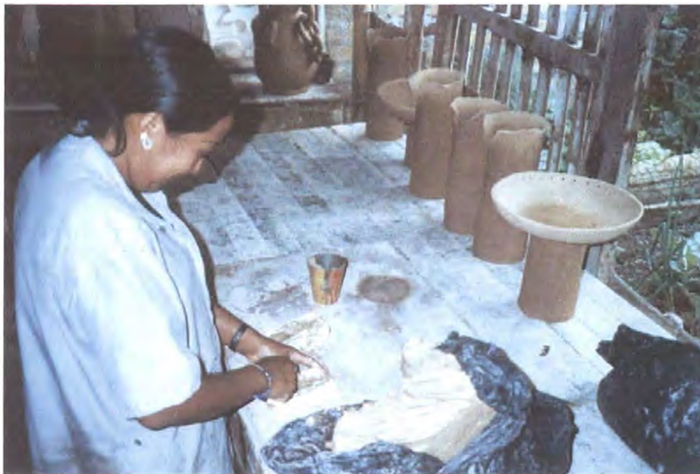
Figura 19. Uso de la arcilla sin ningún tratamiento por parte de los artesanos en la técnica de prensado.
