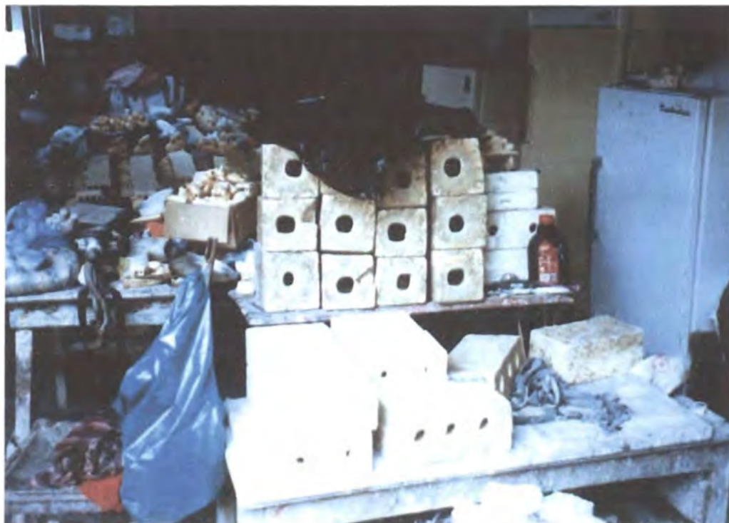
Figura 20. Moldes para vaciado de la arcilla como barbotina en la elaboración de "cascarones" de chivas.
