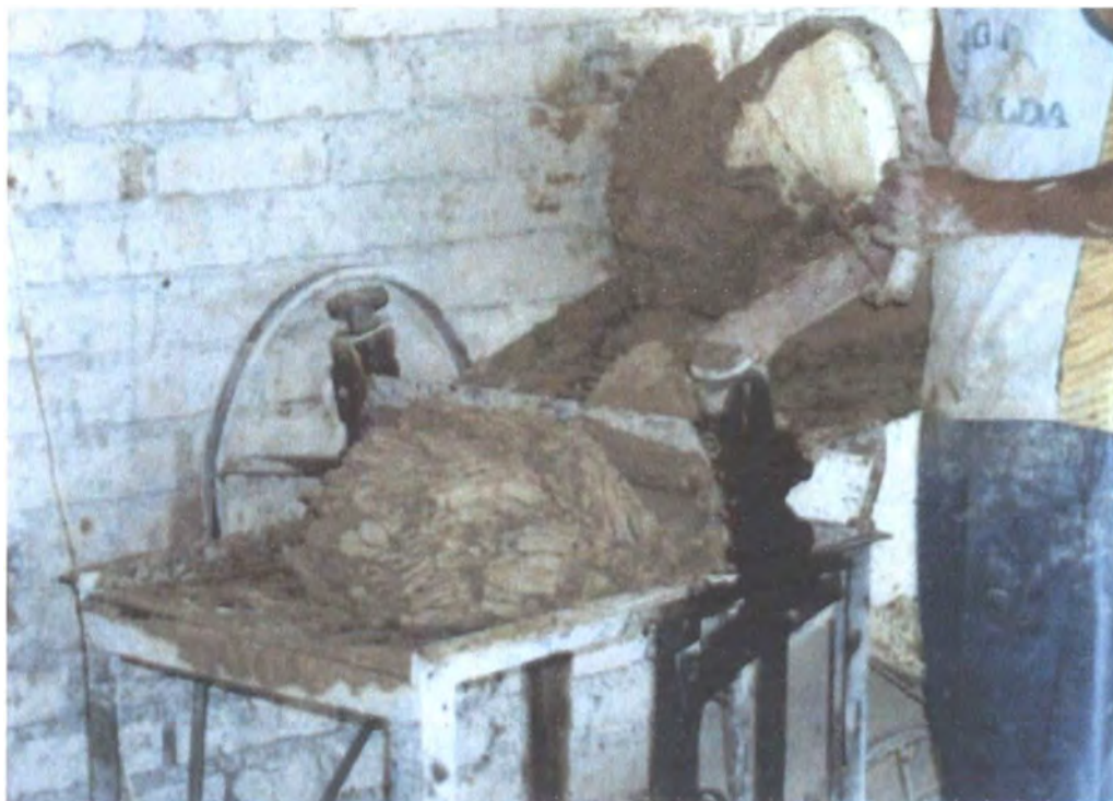
Figura 16. Beneficio de la materia prima mediante el proceso de laminado en el taller de beneficio de Aldemar Torres.
