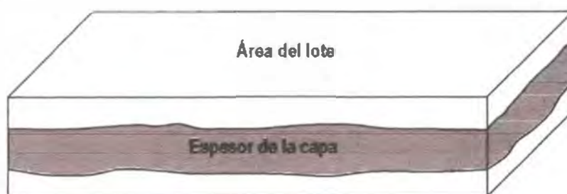
Figura 21. Ejemplo de la geometría tabular del depósito en la mina Salesiano.
