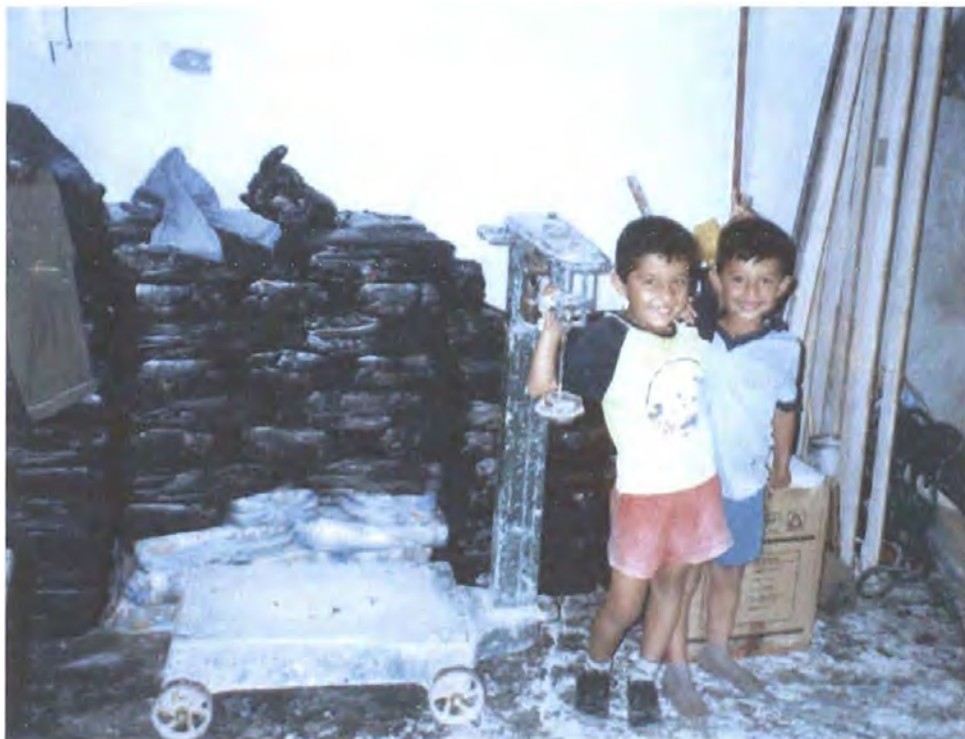
Figura 18. Almacenaje de barro. Después de pesado por arrobas, el barro es empacado en bolsas y almacenado para su posterior distribución (taller de beneficio de Jesús Barreto).
