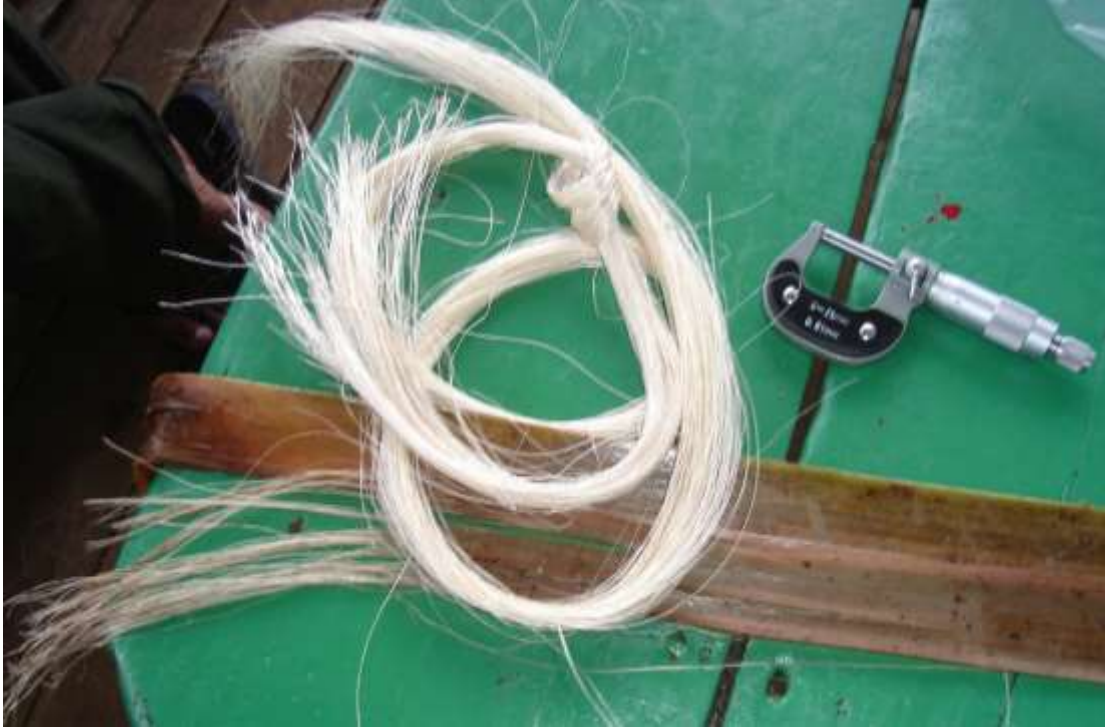
Medición de espesor de la fibra procesada
