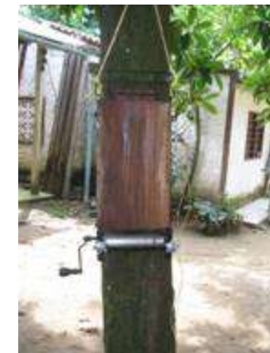
Máquina laminadora para procesar calceta de plátano
