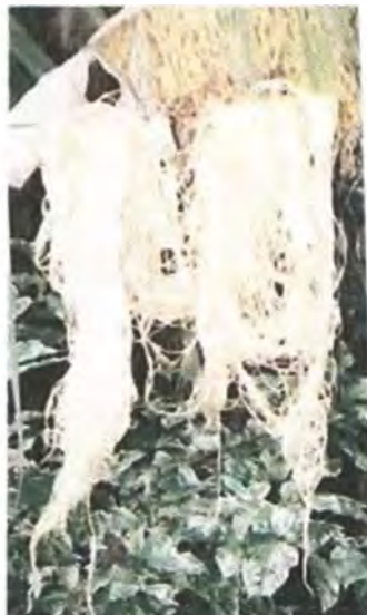
Fibra de cumare tinturada con hoja de chontaduro y sulfato de cobre con vinagre
