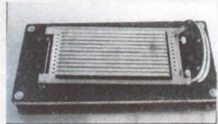
Cortadora para arcilla, implementada para la fabricación de las asas.
