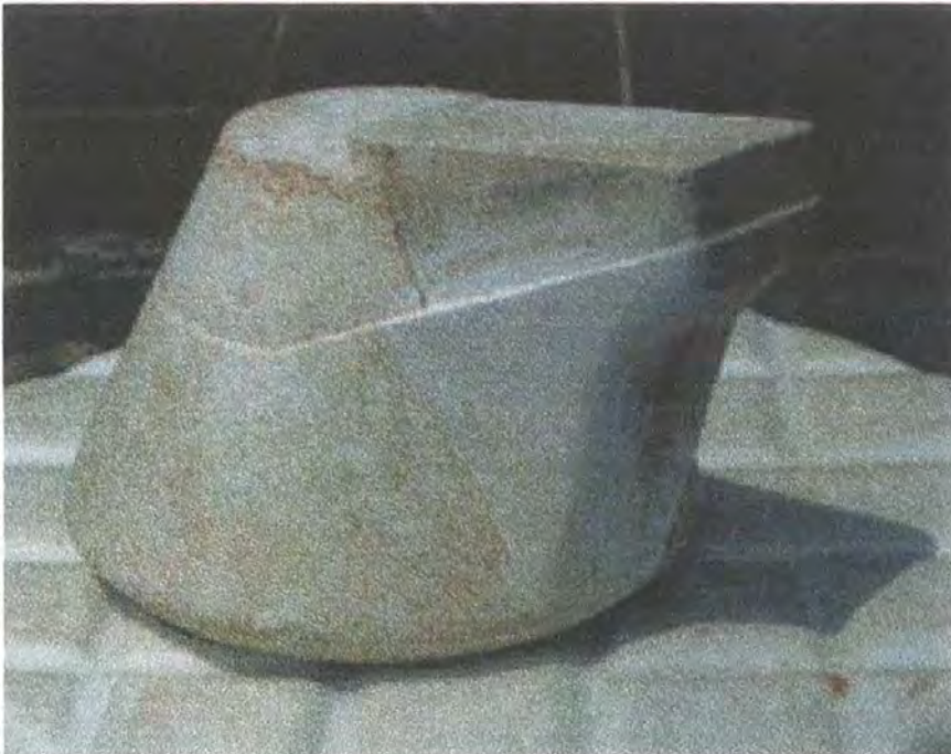
Detalle de la relación entre la superficie del molde y la cuchilla del torno de tarraja.
