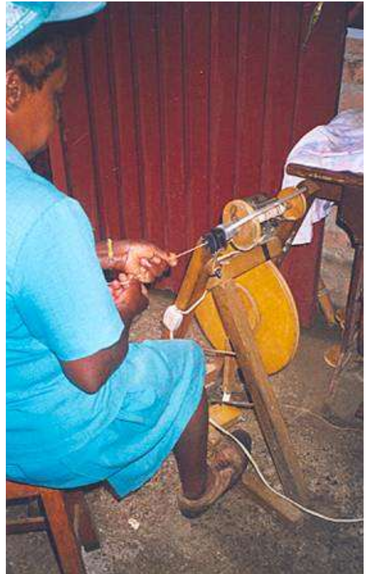
Hilado de figue en rueda
