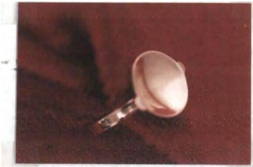
Las bateas de los aretes se perforan en las manijas para asegurarlas. Abajo se entrelaza con un eslabón hecho en un alambre 0.85mm. que sube y se devuelve formando una "U" invertida que sostiene el arete. En la manija de arriba el alambre se asegura.
