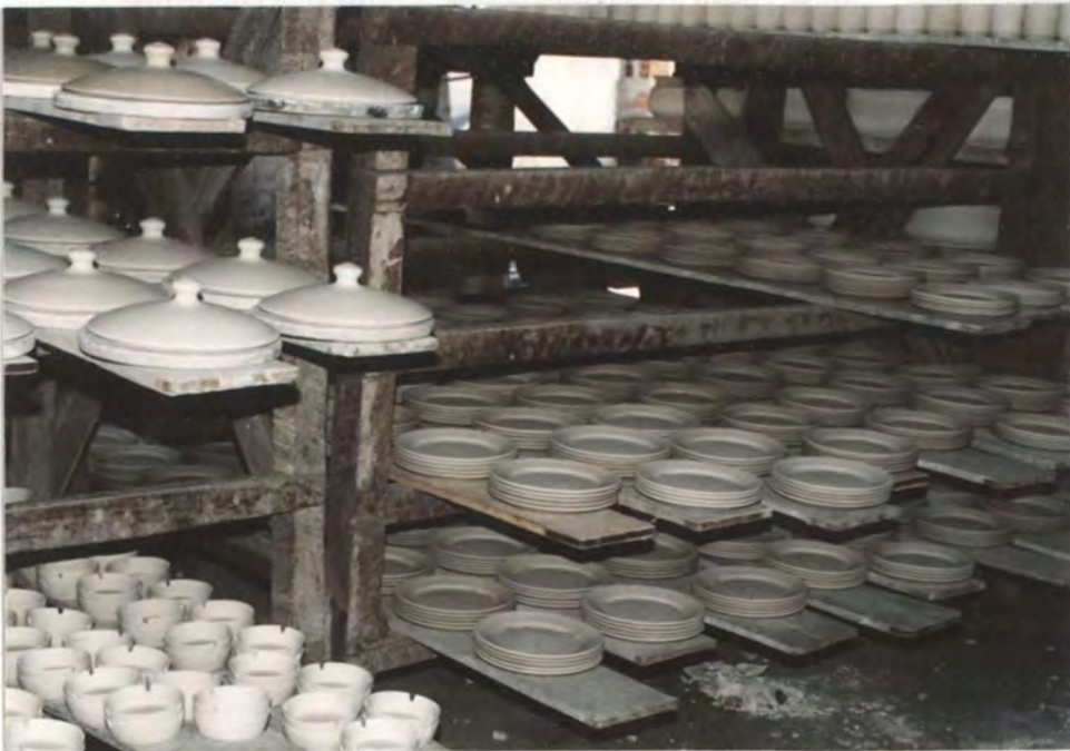
91. Pulido de las piezas. Proceso de secamiento.
