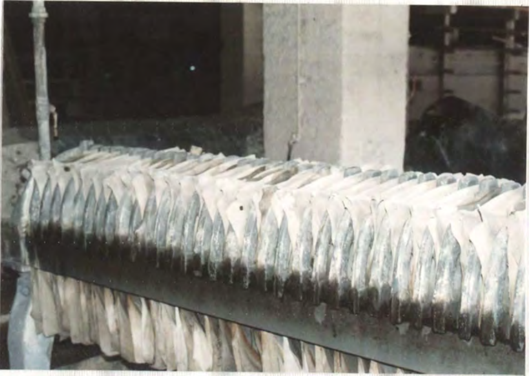
39. Eliminación del exceso de agua por medio de la filtración
