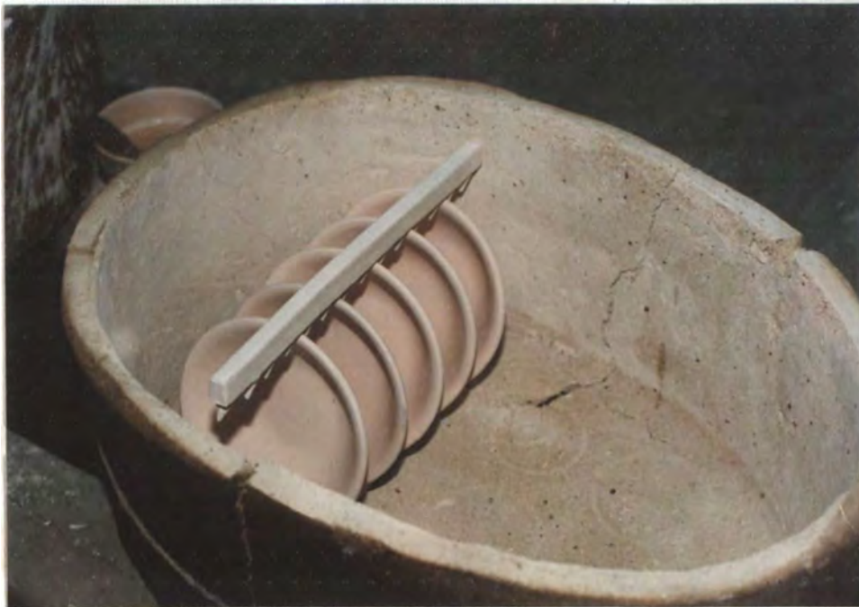
132. Ubicación de platos dentro de los estuches. Fábrica Continental.
