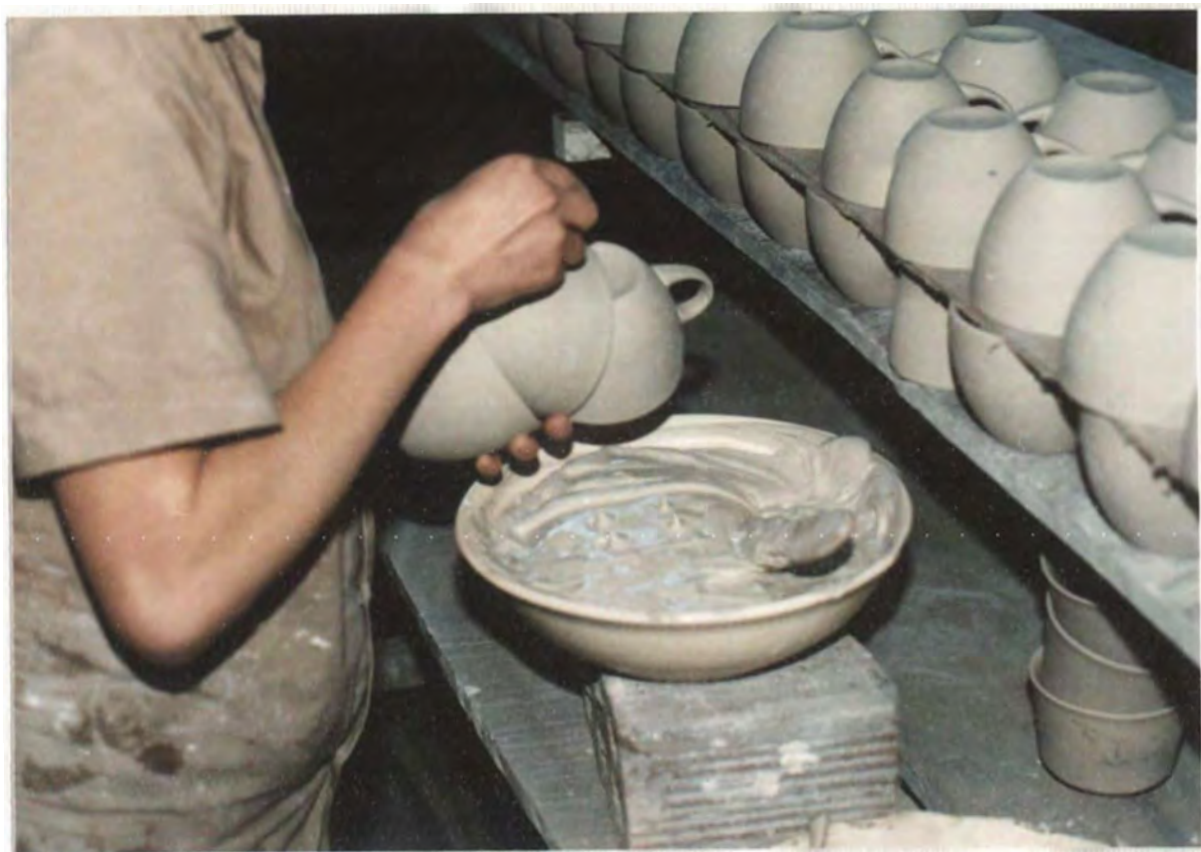
74. Colocación de orej s en pocillo B rbotina. Conti ntal.
