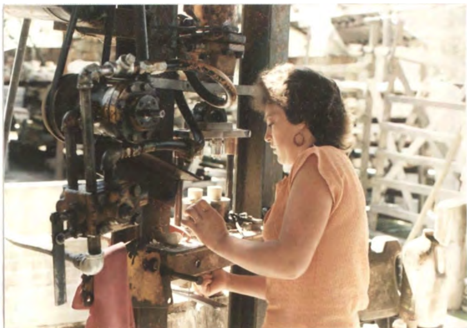
155. Extracción de piezas moldeadas. Porcelana Delta.
