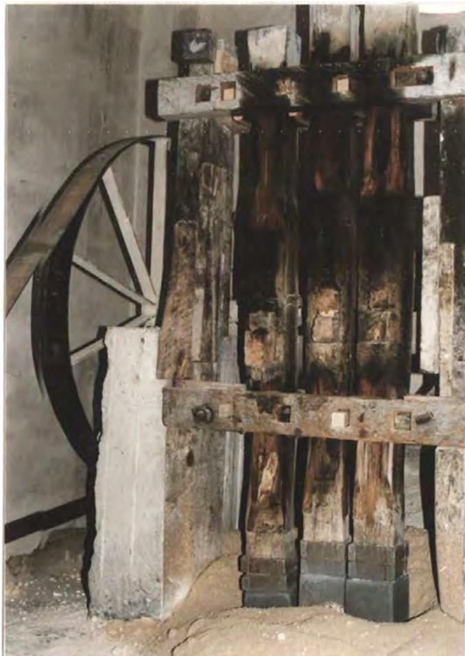
26. Detalle de los molinos de Pisón o Martillos Californianos. Este proceso lo realizan dos fábricas y algunos talleres artesanales.
