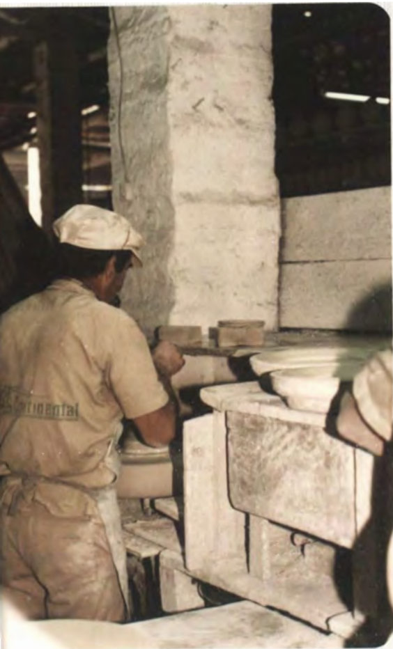
56. Torneado con Terraja sobre torno movido por electricidad
