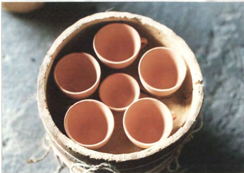
133. Estuche cargado de platos apoyados en caballitos o soportes.
