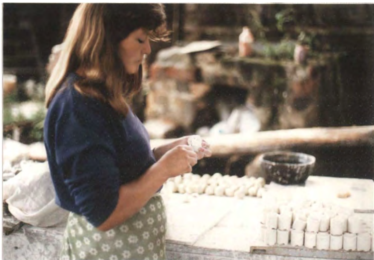
158. Luego de moldeadas las piezas se pulen.
