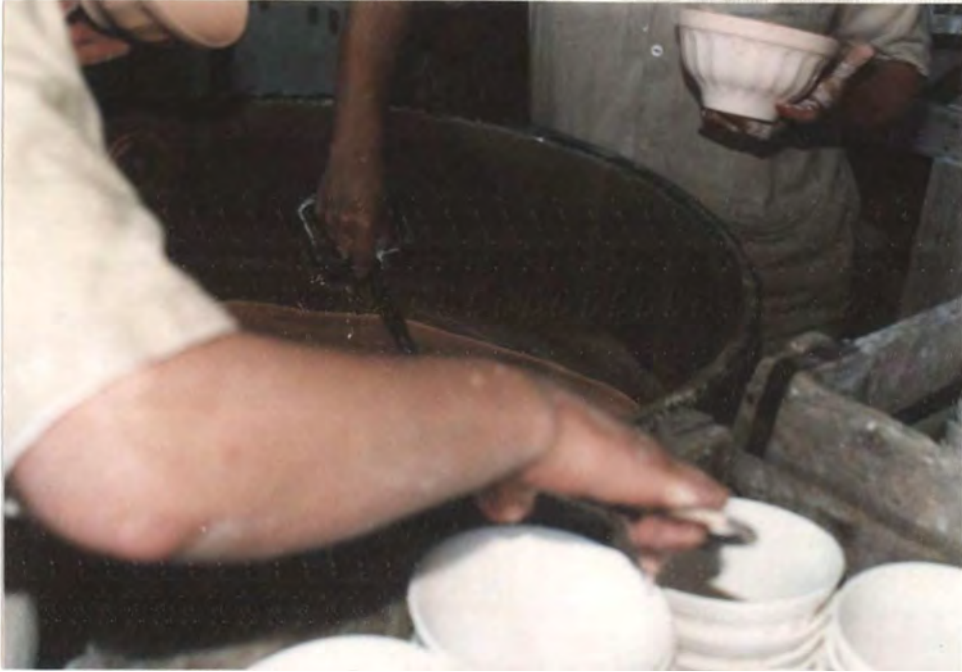
123. El esmalte ya preparado se deposita en grandes canecas.
