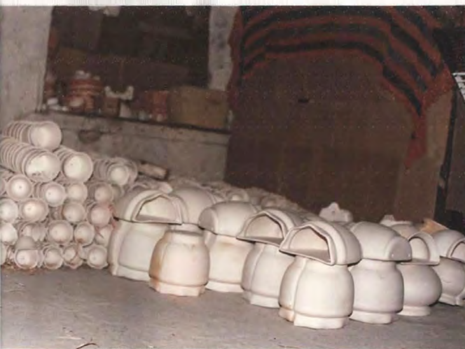
190. Producción Bizcochara. Primera y única quema. Cerámica Júpiter.
