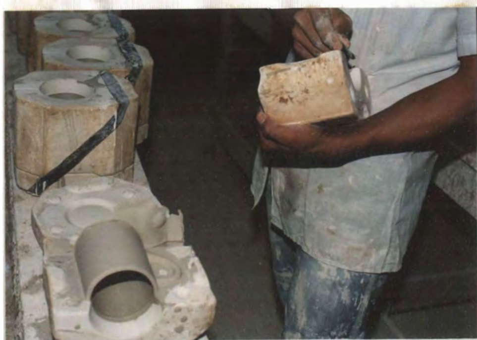
88. Limpieza de moldes del exceso de pasta.
