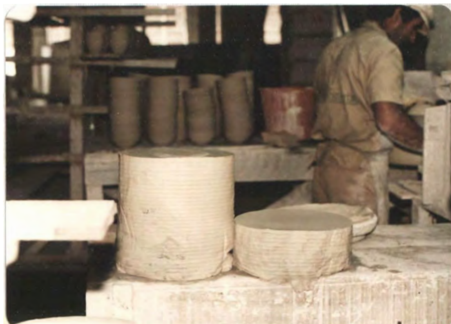
59. Corte en Telas o círculos para hacer platos.
