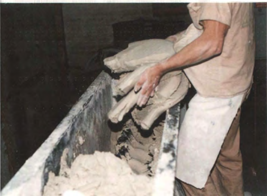
48. Detalle co- locación en ama- sadora. Fábrica Continental
