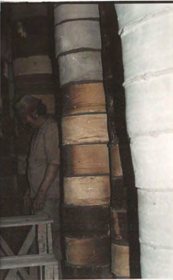
135. Carga de horno con estuches llenos de piezas esmaltadas. Fábrica Continental
