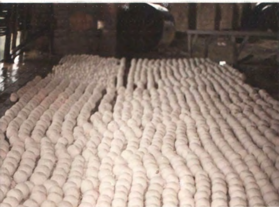
30. Bolas de loza ya quemadas para el interior del molino
