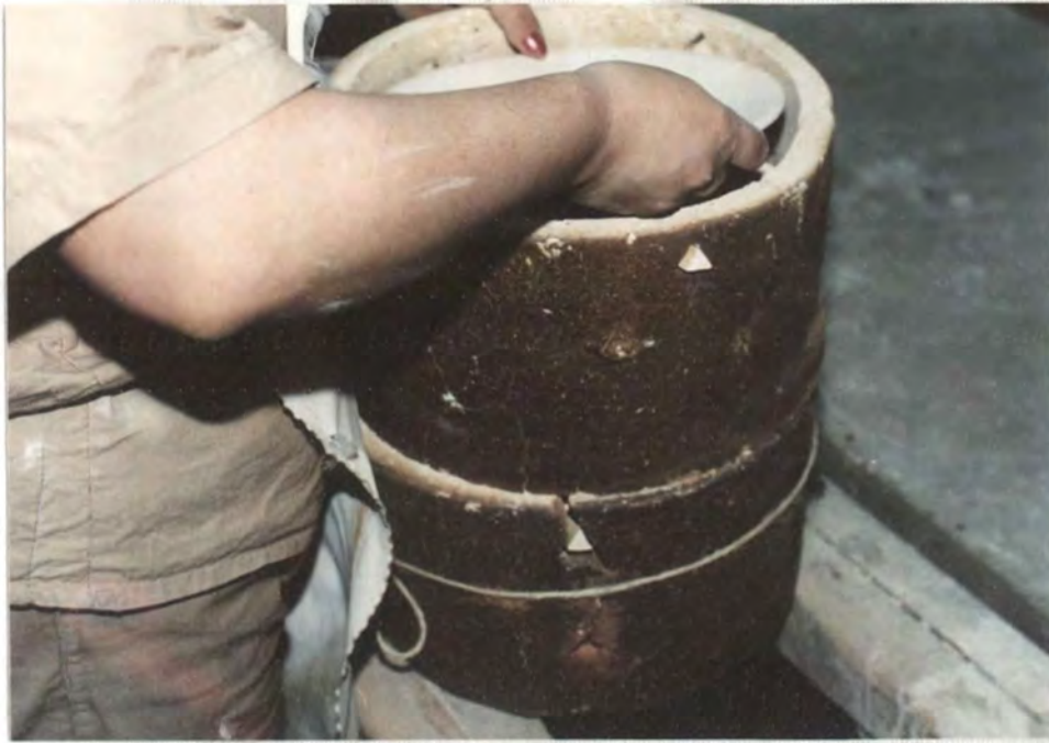
131. El estuche se cubre con un plato par evitar contaminación.
