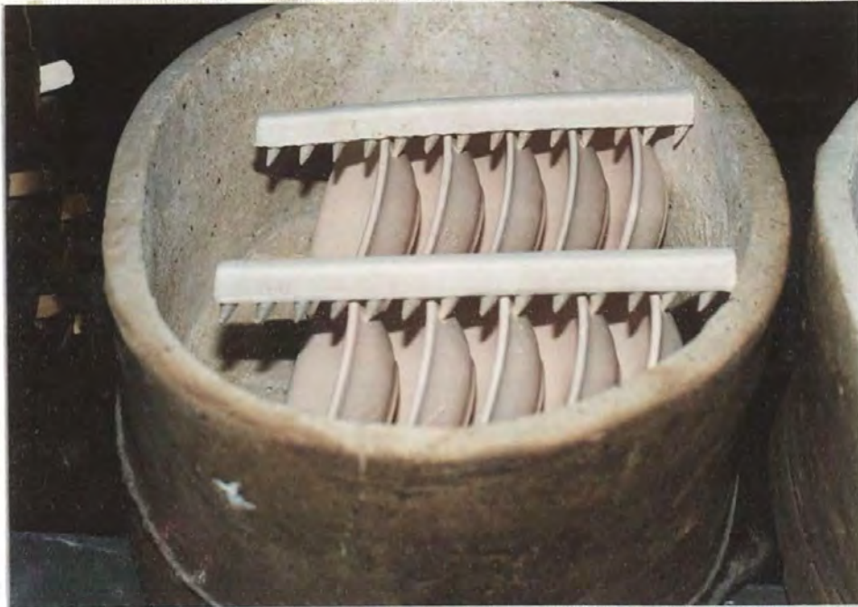
133. Estuche cargado de platos apoyados en caballitos o soportes.
