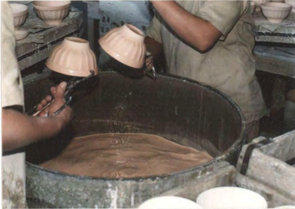
125. La pieza absorbe inmediatamente el esmalte.
