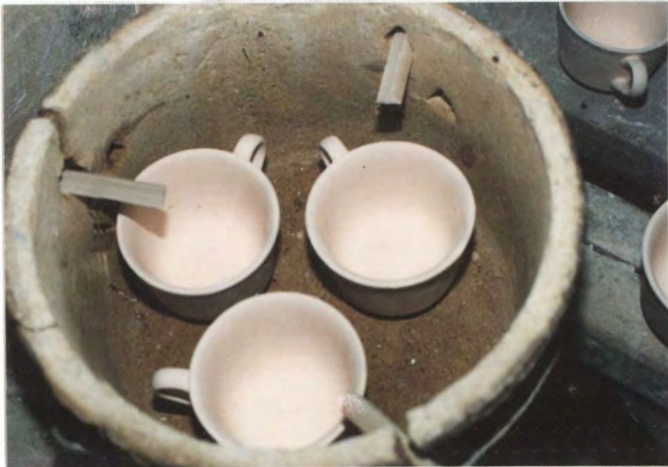
130. Colocación de piezas dentro de los estuches.
