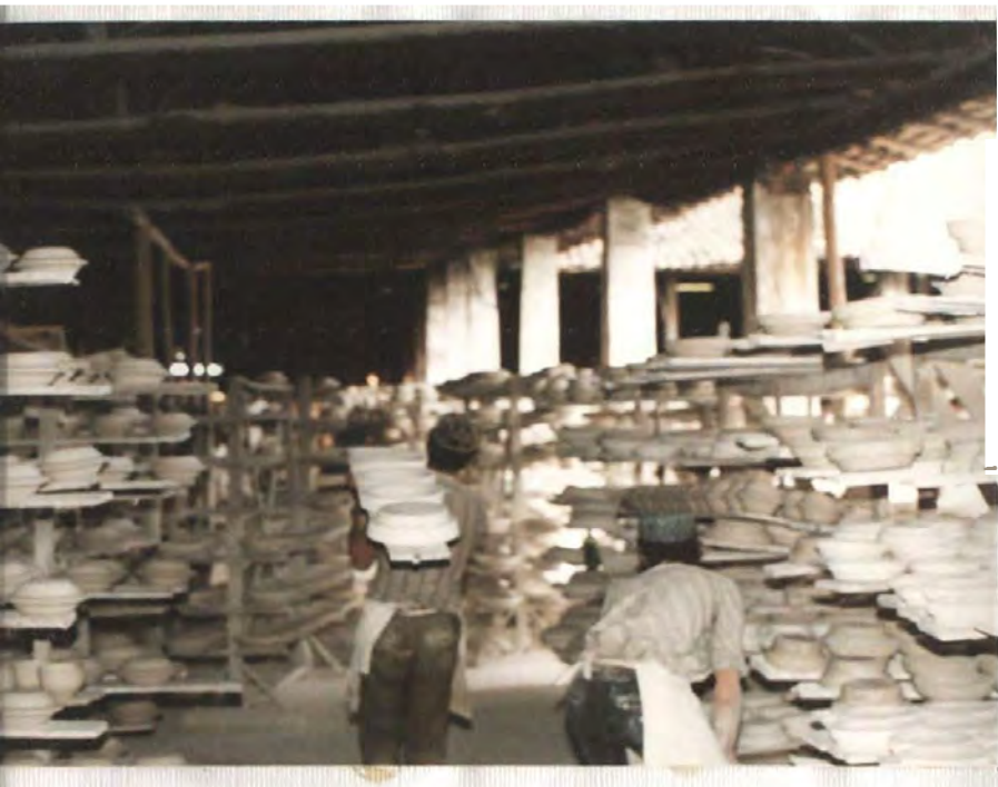
81. Traslado de moldes húmedos para etapa de secamiento. Fábrica Continental
