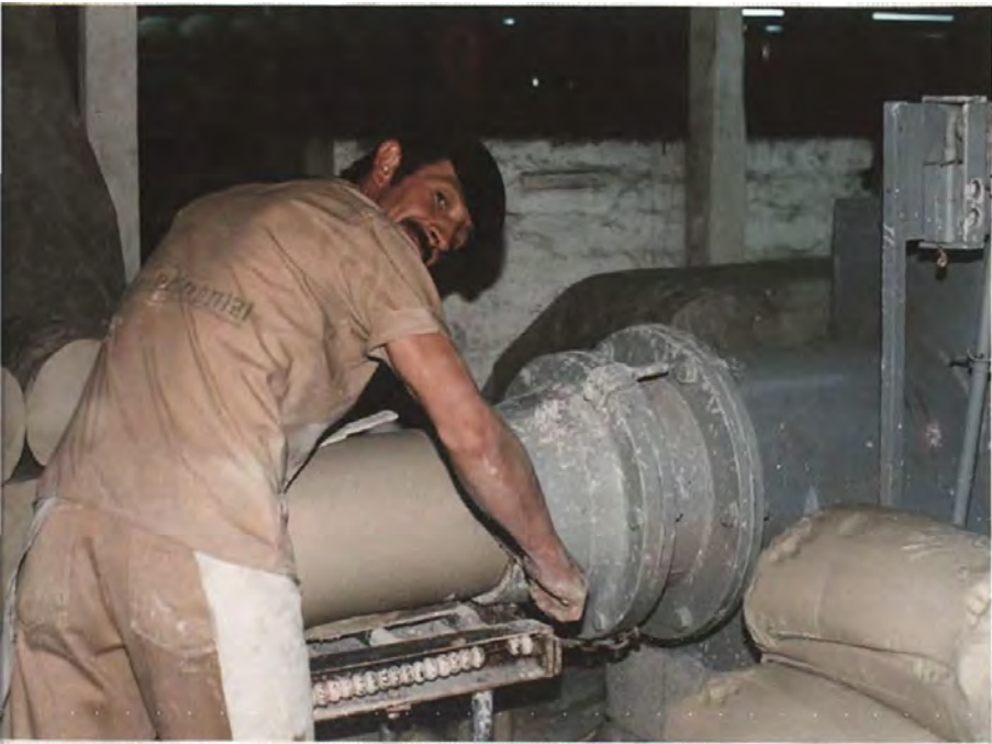
51. Corte de la Peya o trozo de pasta. Fábrica Continental
