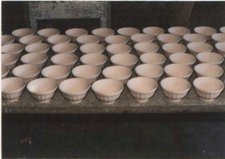
126. Luego del esmaltado las piezas se dejan secar totalmente. Fábrica Continental.
