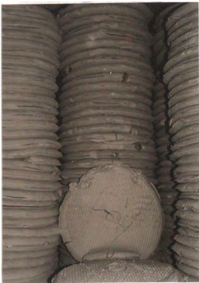
42. Detalle de la pasta extraída de la Filtroprensa, en esta forma se l llama "galleta". Fábrica Continental
