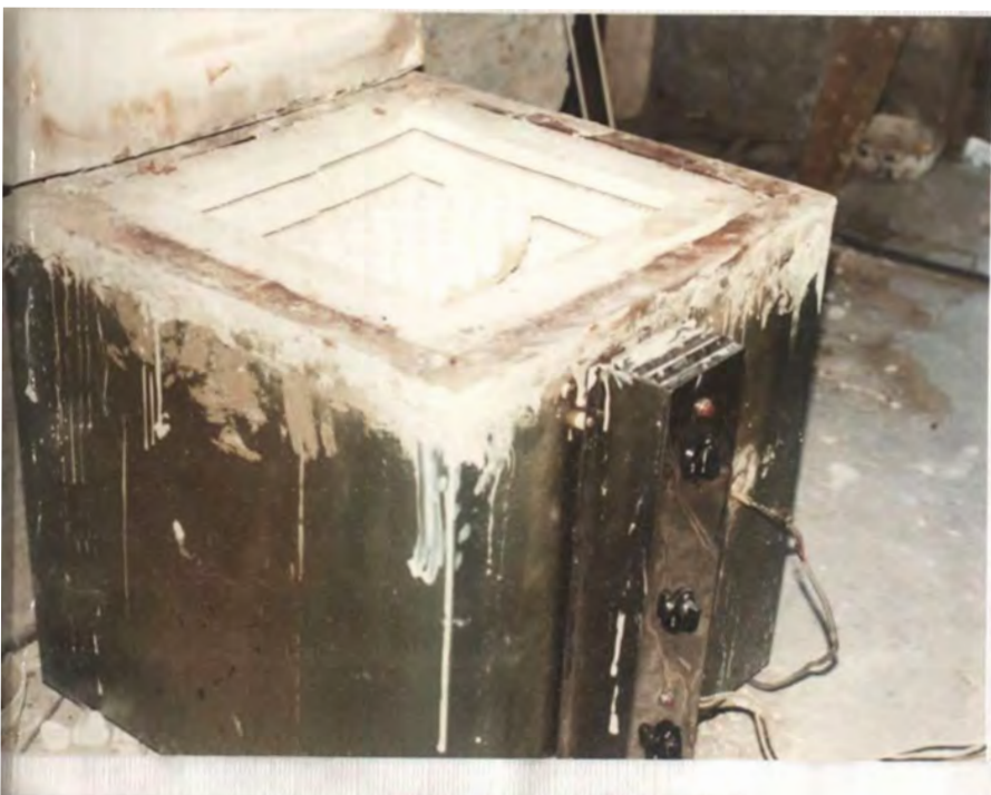
162. Horno eléctrico lleno con artículos eléctricos. Porcelana Delta
