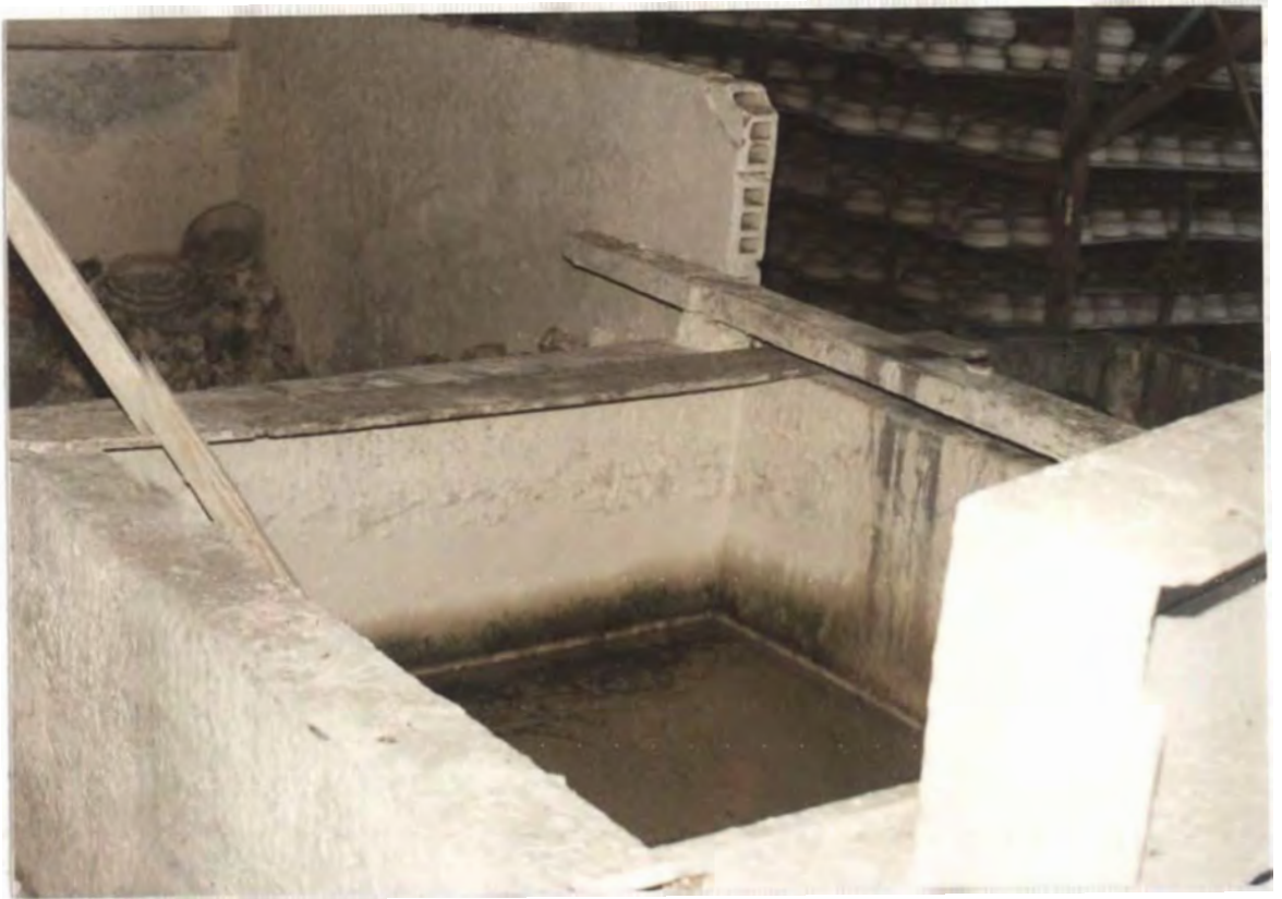
35.. Disolución y decantación de minerales blandos. Artesanías El Progreso
