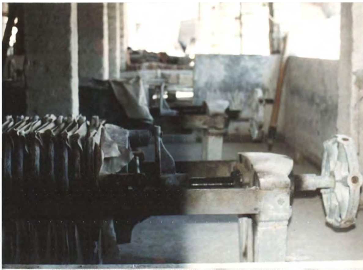
41. Detalle de Filtroprensa. Este proceso lo realizan las Fábricas Continental y El Capiro.
