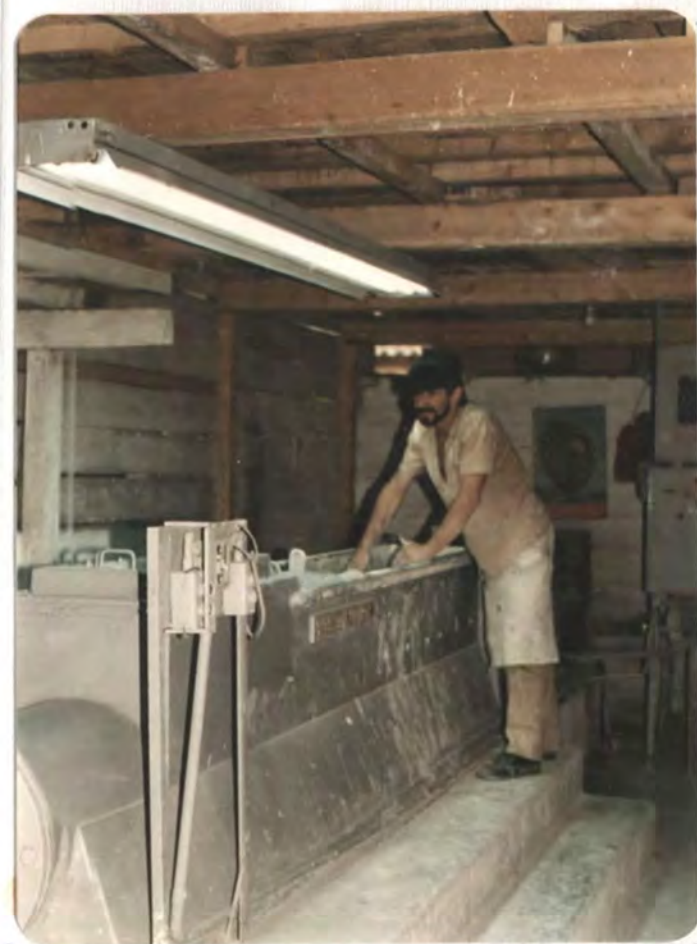
46. Amasado una vez obtenida la "galleta" se lleva a la amasadora al vacío. Fábrica Continental.
