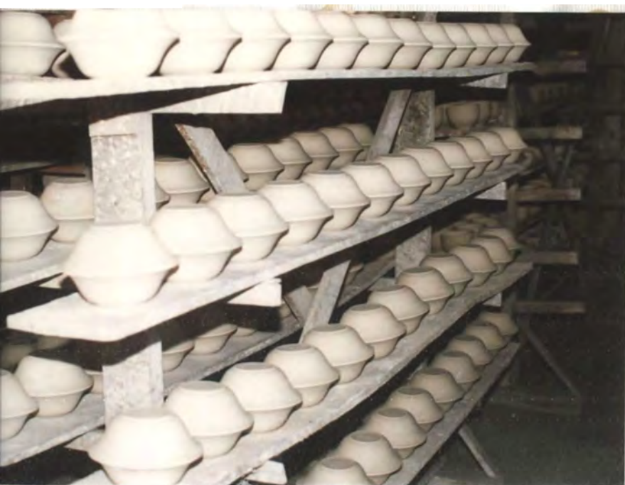
78. Piezas en etapa de secamiento. Taller Artesanías El Progreso
