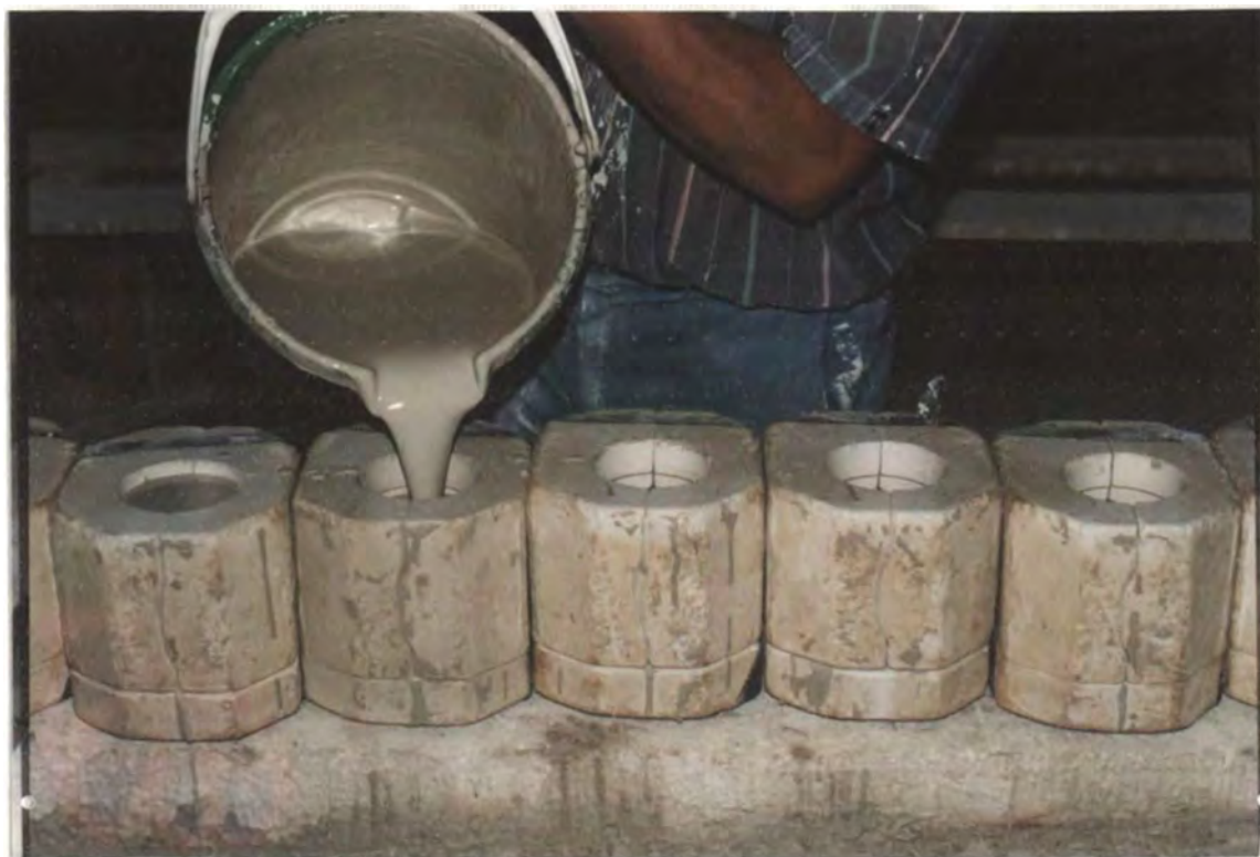
177. Colado de moldes.
