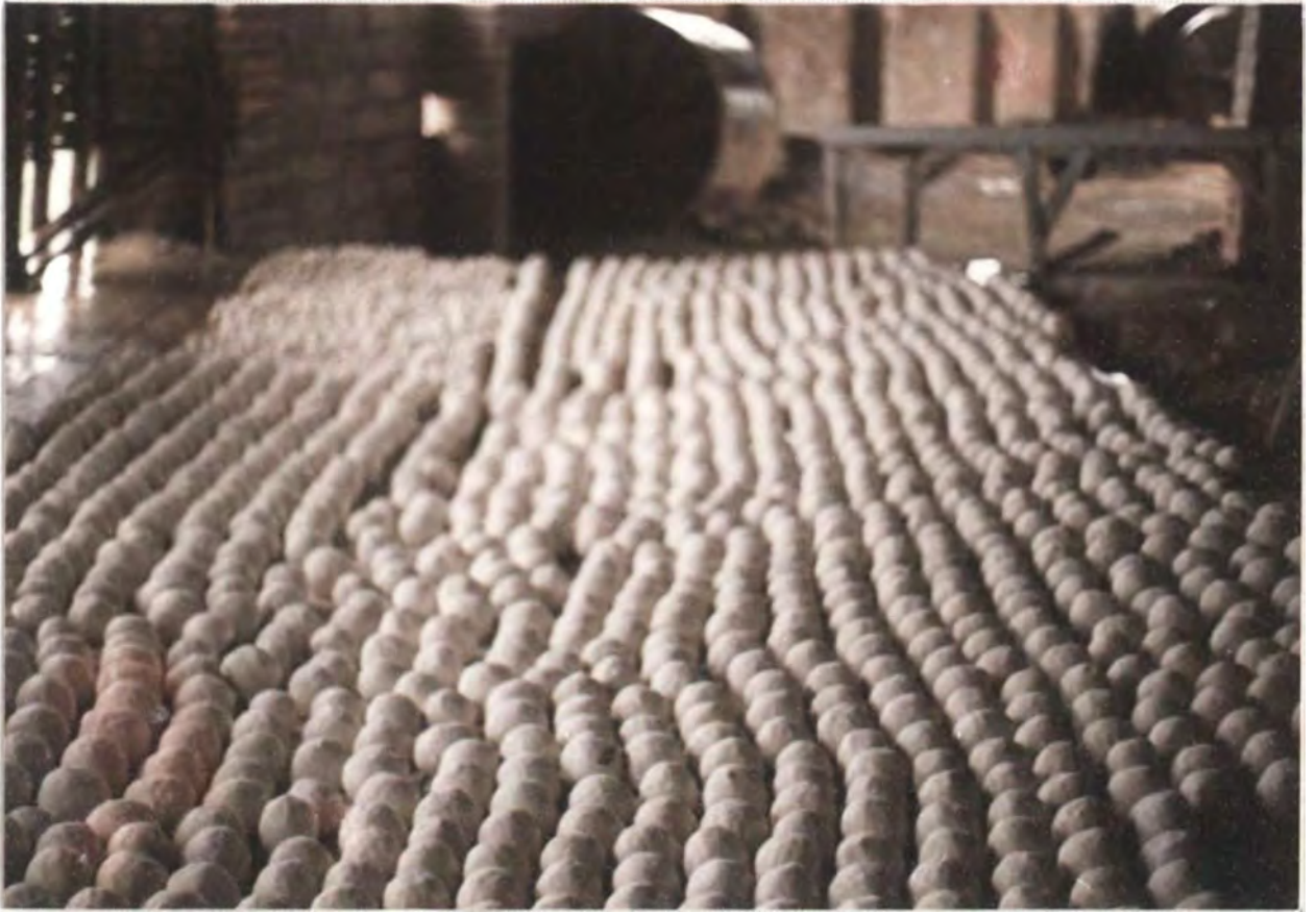
150. Preparación de bolas para molino. Porcelana Delta.
