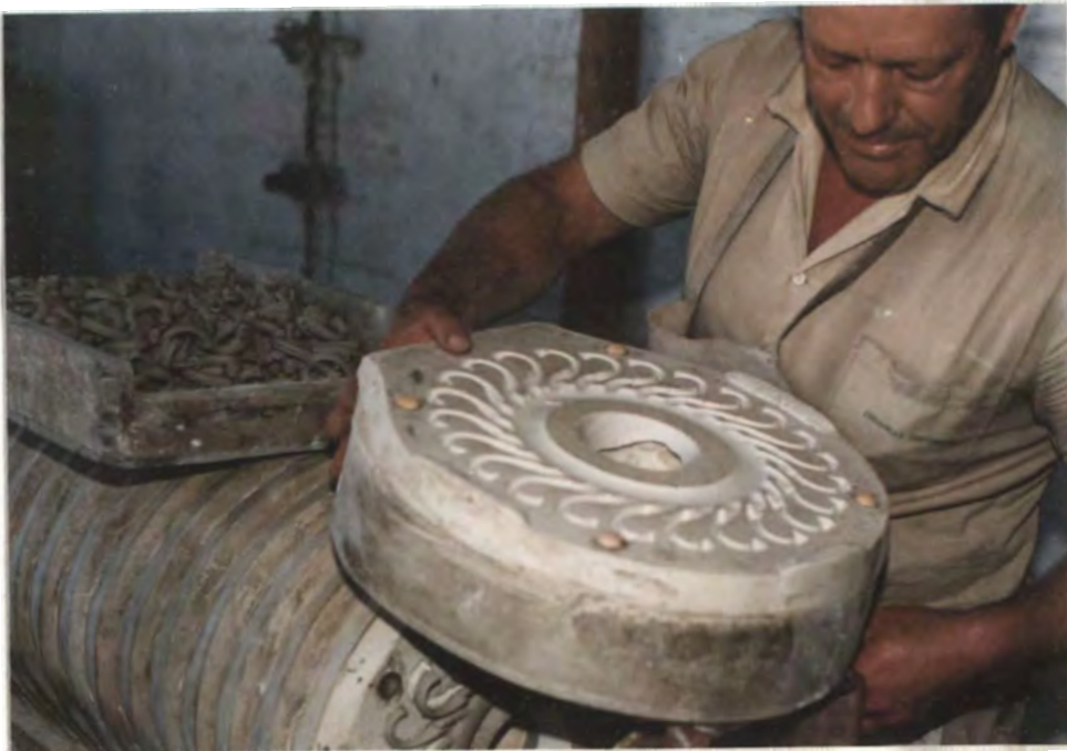
71. Detalle de desmoldeo de orejas de pocillo.
