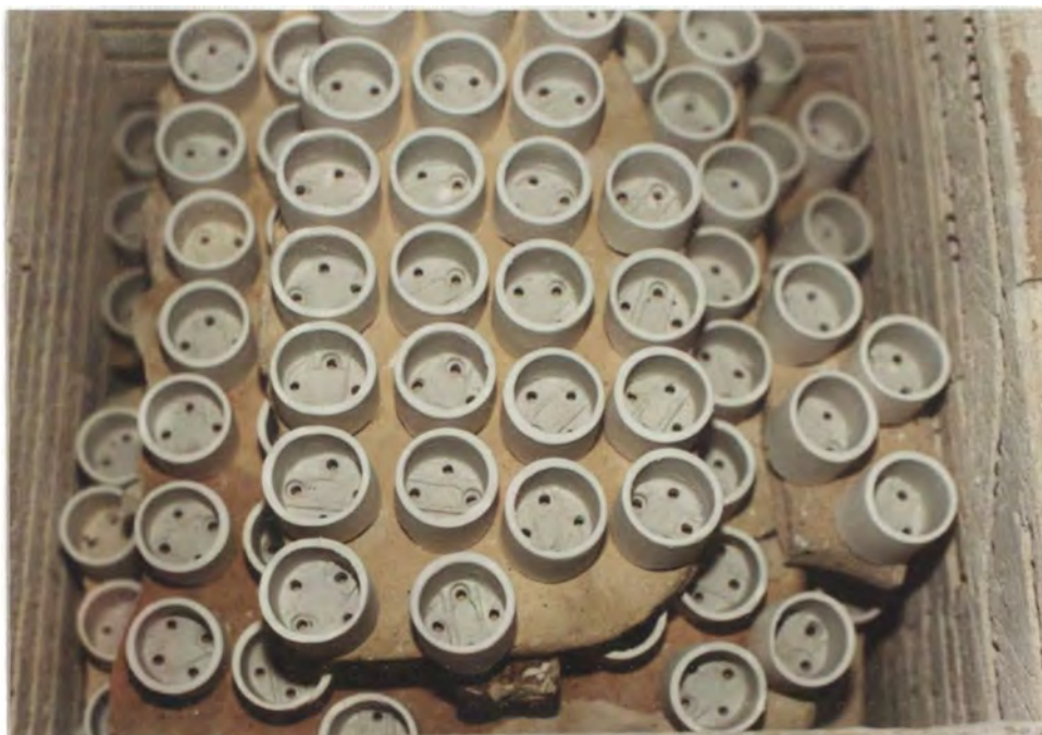
161. Piezas para ser cocidas en horno eléctrico.
