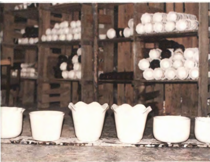
194. Piezas esmaltadas secando el esmalte. Cerámicas Júpiter
