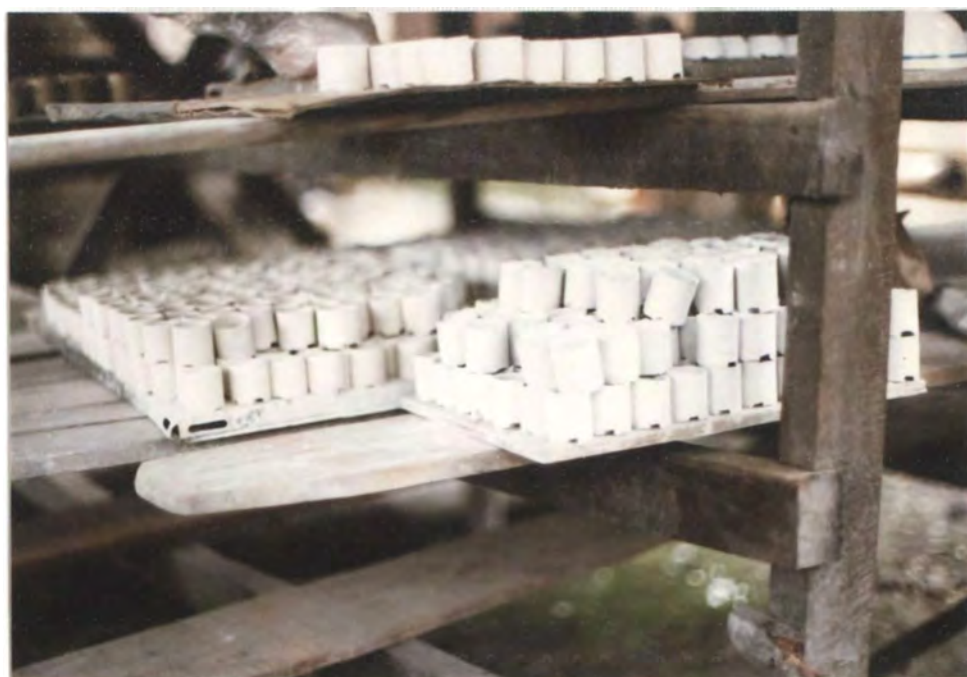
159. Proceso de secamiento de las piezas Porcelana Delta.
