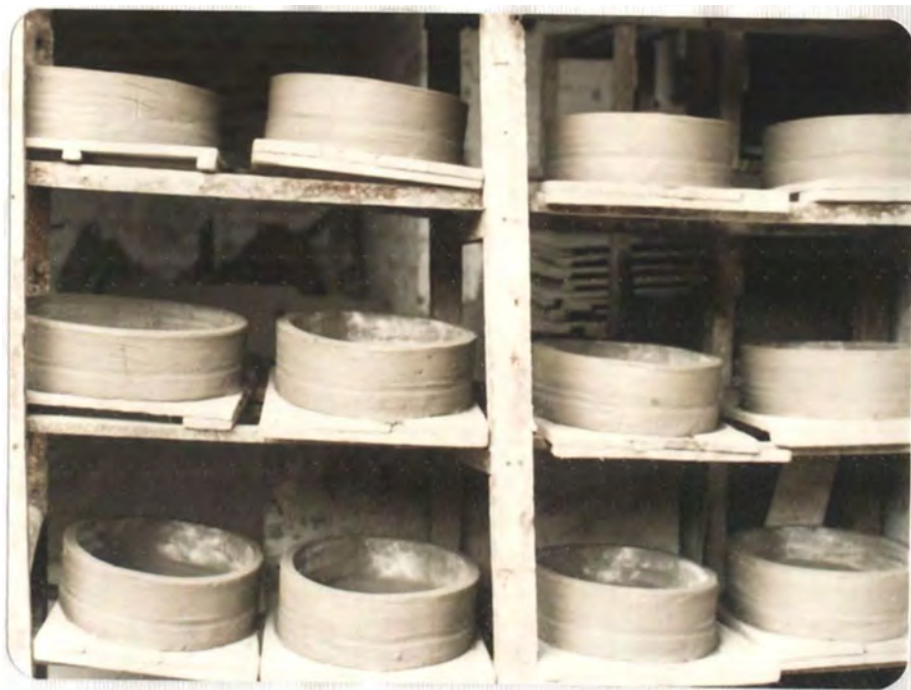
96. Los estuches se hacen manualmente. Se dejan secar.
