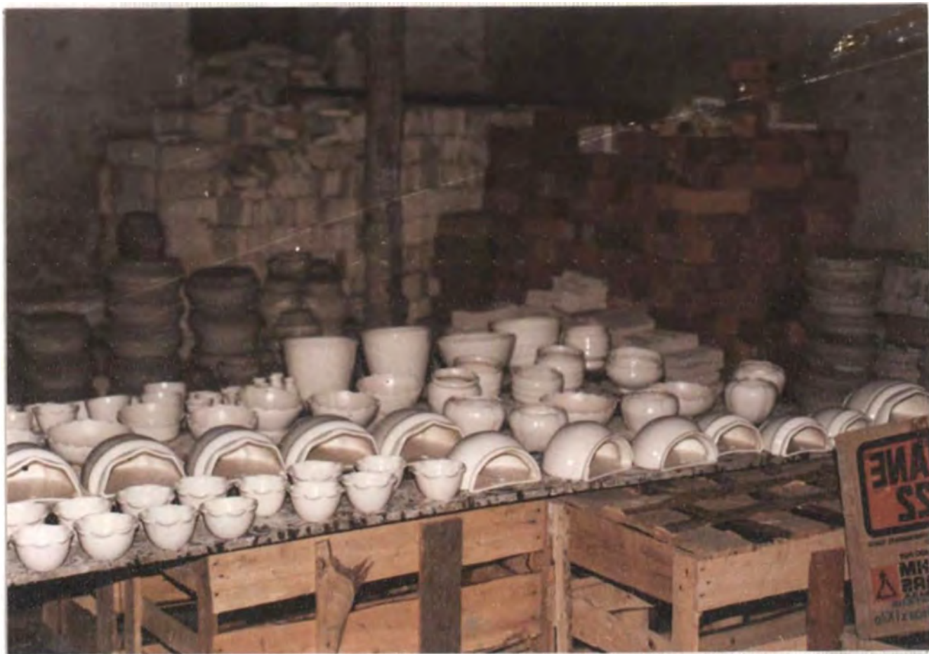
195. Piezas esmaltadas secando el esmalte. Cerámicas Júpiter.
