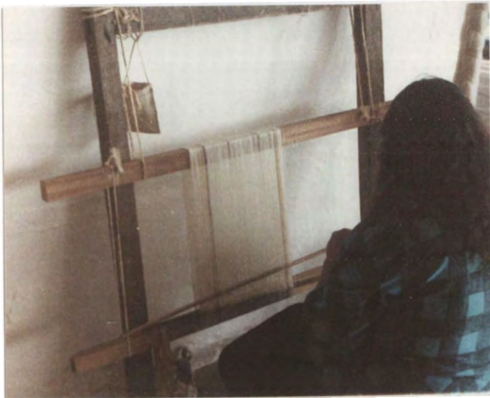
MONTAJE DEL ARMADO (URDIDO)
