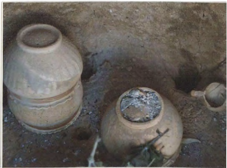
(foto 7) Interior del horno donde se colocan las piezas. Se observan los desfogues.
